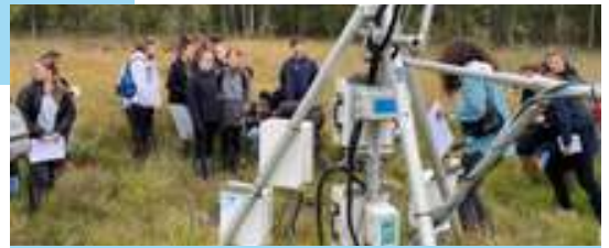
Des capteurs de \text{CO}_2 et \text{CH}_4 pour suivre l'état de santé de la tourbière, présentés par Line, chercheuse au CNRS
