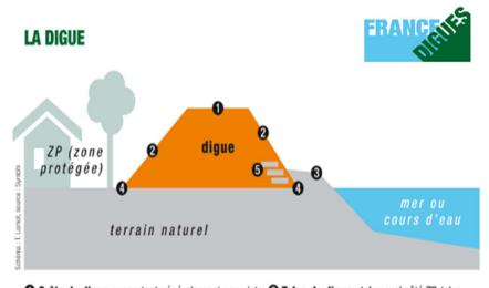
① Crête de digue supportant généralement une piste. ② Talus de digue : talus aval côté ZP, talus amont côté eau. ③ Berge. ④ Pied de digue. ⑤ Protection anciennes : perré, lauzes...
