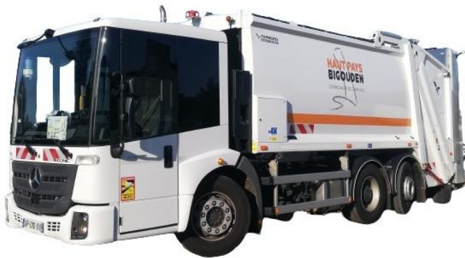
Véhicules de collecte des déchets (V.C.D) de 11.5 tonnes de charge utile
