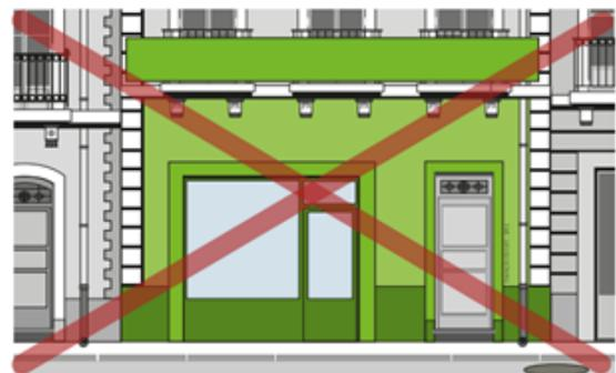
La porte d'entrée de l'immeuble, les fenêtres du rez-de-chaussée, le balcon ne peuvent en aucun cas être recouverts par les coffrages ou par l'enseigne.
