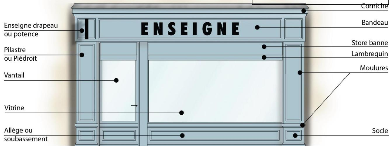
*La devanture en applique est souvent réalisée par des ensembles menuisés en saillie, renforçant ainsi la signalétique. Enseignes, systèmes de fermeture et éclairage sont soigneusement intégrés dans cet ouvrage, sans dépasser l'emprise de la devanture*
