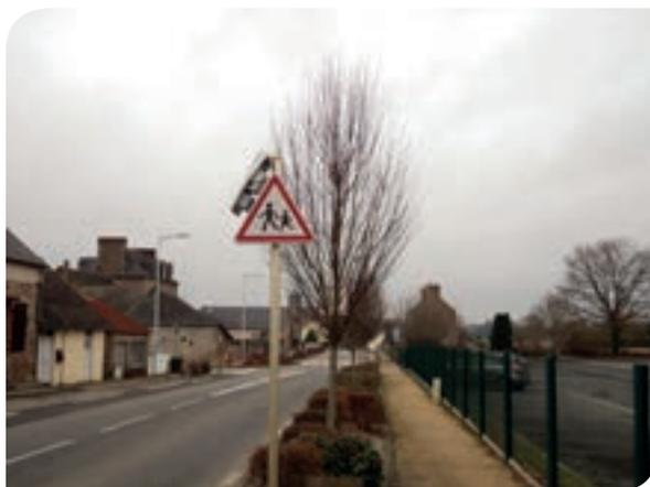
Ces panneaux possèdent une alimentation solaire et une horloge de programmation qui permet l'activation de la source lumineuse aux seuls horaires scolaires.
