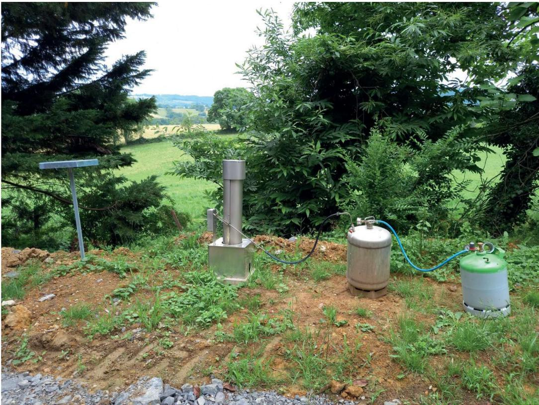
Dès que c'est nécessaire, la société de détection KERAUNOS à Toulouse, contacte tous les possesseurs de poste, qui déclenchent les générateurs antigrêle en craquant une allumette. L'air comprimé que l'on met sous pression (grâce à un compresseur) va pousser de l'iodure d'argent.
