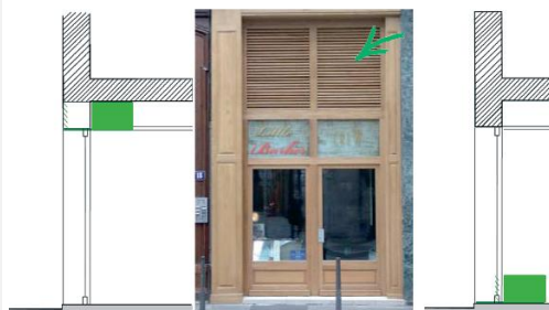
Climatiseur situé derrière le linteau (à l'intérieur du commerce)
