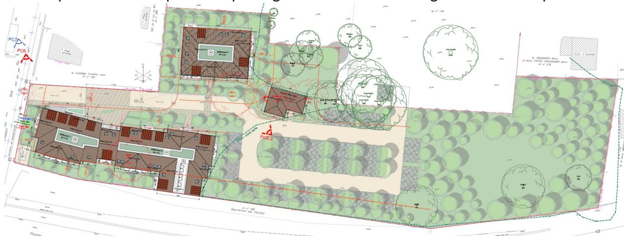
Au niveau du bassin de gestion des eaux pluviales, nous ne prendrons pas en compte le volume de gestion dans le calcul des volumes de compensation. Le plan ci-dessous met en évidence des cotes d'entrées en terres du bassin à 24.40m NGF. Le parking a quant à lui des cotes situées entre 24.50 et 24.80m NGF.
