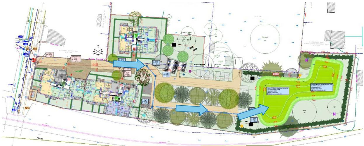
Figure 23 Plan de gestion des eaux pluviales (cf. annexe 9)
