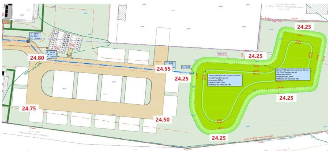
Figure 27 Plan du parking et du bassin de gestion des eaux pluviales dans l'emprise PPRI
