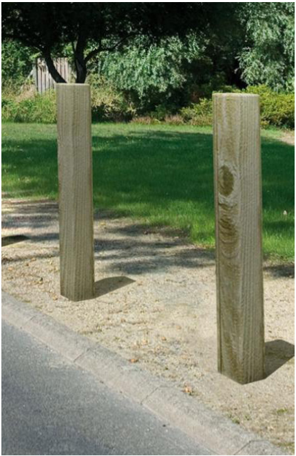
Borne bois carrée Chêne section 12 cm, hauteur minimum 1,00 m hors sol Pour les traversées piétonnes dans espaces verts
