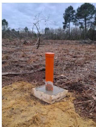
Figure 12 : Photographie du piézomètre PZ2 (Réalisation : CERAG)
