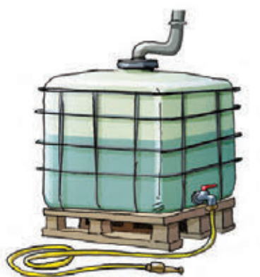
Cuve de récupération d'eau de pluie
