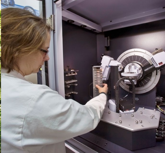
▲ Opération de de caractérisation de sols et diffractométrie des rayons X. © TERRA - LAURENT MIGNAUX
