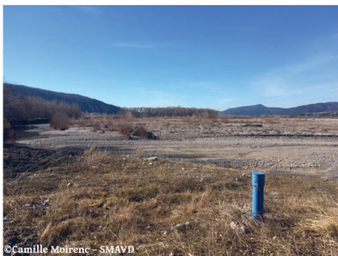
Piezomètre positionné en Basse Durance pour effectuer des mesures de la hauteur de la nappe.
