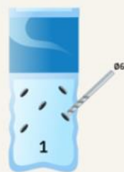
Chauffer le forêt Ø6 et percer 5 ou 6 trous dans le corps de la bouteille n°1, ils serviront de sortie pour les abeilles
