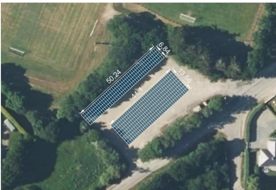
La surface couverte serait de 580m<sup>2</sup> correspondant à 296 panneaux, produisant une puissance de 190 kWc (kilowatt crête)
