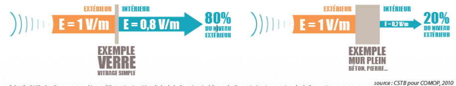
Réduction de l'exposition (E) par les fenêtres et les murs (Source : Fédération Française des Telecom, 2012).
